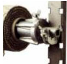
Unutarnja četiri kuta omogućavaju umetanje poluga za nošenje, dizalice, ručnih kurblji ili el. prijenosnika za namatanje.
