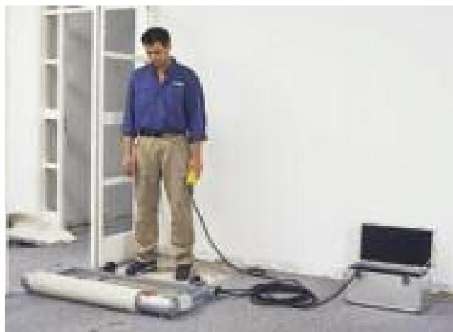
Rukovanje ručnim upravljanjem prema naprijed i natrag potpuno sigurno, jer se pogonski valjak kreće samo pri 13 o / min. rotira i ugrađeni snažni istosmjerni motor zahtjeva samo 60 volti.
