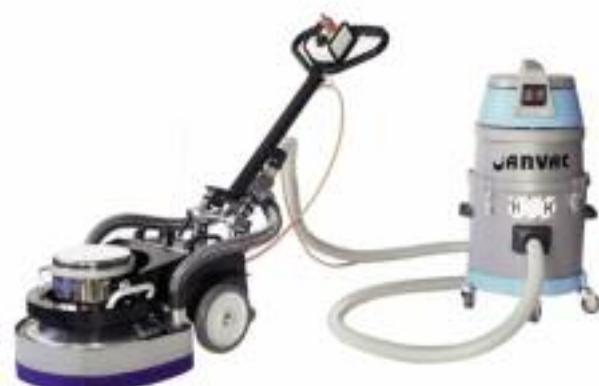
Slika prikazuje brusilicu SPEEDTRONIC s usisnim sistemom
