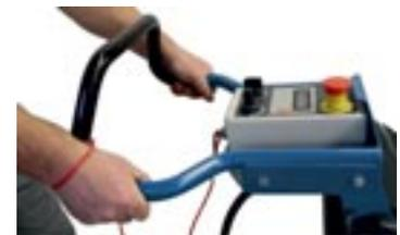
Display mit Leistungsanzeige und Betriebsstundenzähler
