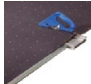
Schneiden mit USF, Winkelanschlag und Teppichschneider mit Niederhalter.
