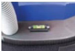
Wasserwaage zum Einstellen des Schleiftopfes, dadurch gleichmäßige Abtragsleistung am Boden.
