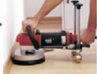
Beim Schleifen von Treppenstufen können die Stellräder zur Führung auf der unteren Stufe bis zu einer Höhe von 22 cm eingestellt werden.
