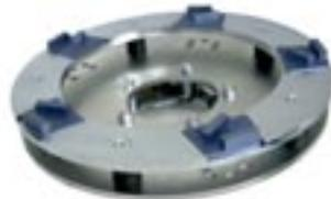
Durch die konische Lagerung können die QUICK-CHANGE Segmente einfach in die Aussparung geschoben und mit Kunststoffhammer fixiert bzw. gelöst werden.
