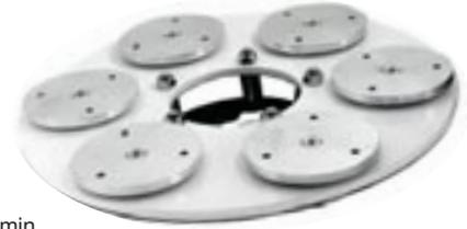
Gegenläufige Drehrichtung der Satelliten mit ca 500 U/min. (ca. 4-fache Geschwindigkeit zur Umdrehungszahl des Shuttles).
