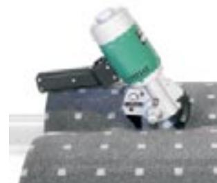
Elektrischer Kreisschneider USM-G mit USF-Schiene
