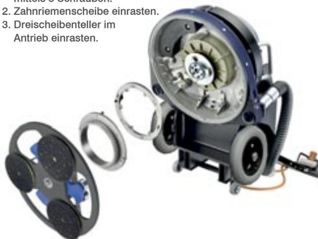
Dank Zahnriementechnik weniger Vibration, mehr Laufruhe und weniger Verschleiss.
